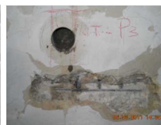
Estrazione di carota in cls abbinate alla verifica della carbonatazione e al controllo delle armature in un edificio multipiano residenziale a Pescara (foto dell'autore).
