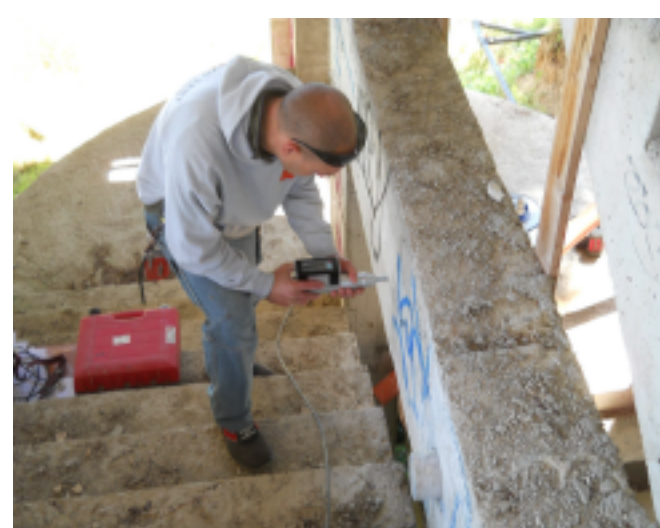
Estrazione di carota abbinata alla verifica della resistenza in una trave in c.a. di un vano scala in una palestra scolastica di Pescara. (foto dell'autore)
